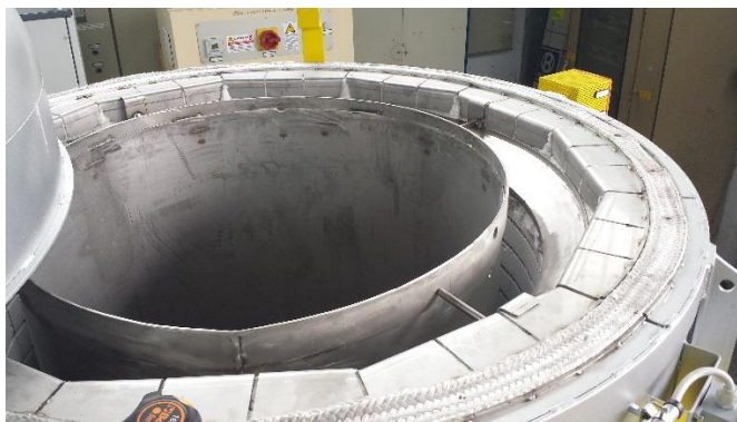
Interno forno con camicia di ricircolo e resistori Fibrothal, coperchio con motore-ventola e deflettore
